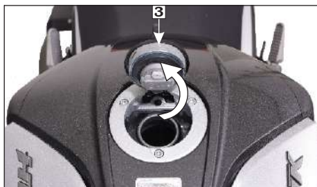
(3) Tapa del tanque de combustible
