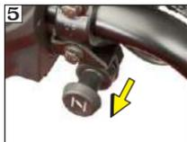
Tire de la palanca del choque hacia afuera a la posición "ON" como se indica (use el choque en condiciones de frío).
