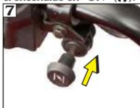
Empuje la palanca del choque hacia adentro hasta la posición "OFF" como se indica, después de que el motor se haya calentado lo suficiente para tener una respuesta estable del acelerador.
