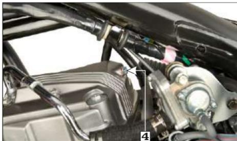
**(4) Perno de control del aceite del motor**
