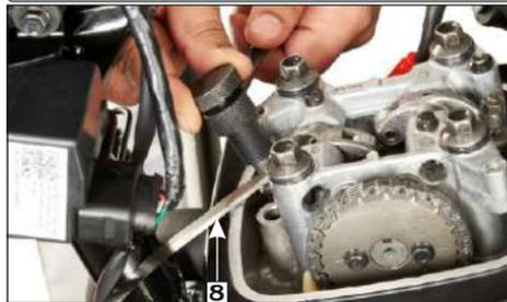
(8) Medidor de espesores
