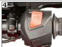
Asegúrese que el interruptor de parada del motor esté en la posición "ON" (O).
