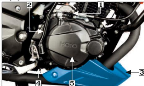
**(1) Cable del embrague (2) Pedal de arranque
