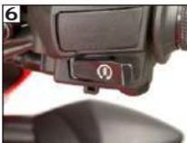
Presione el interruptor de arranque para arrancar la motocicleta. (Como alternativa, se puede utilizar el pedal de arranque para arrancar).
