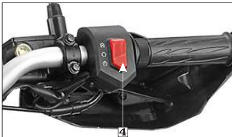
(4) Interruptor integrado arranque y apagado
