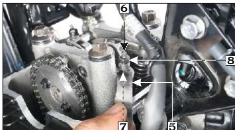
(5) Calibrador de espesores (6) Tornillo ajuste (7) Vástago de la válvula (8) Contratuerca
