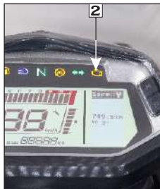
(2) Luz indicadora mal funcionamiento (MIL)
