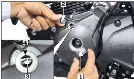
(1) Tapa cigüeñal (2) Tapa orificio de sincronización (3) Marca “T” (4) Marca índice
