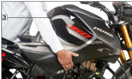
**(3) Cubierta del tanque de combustible**
