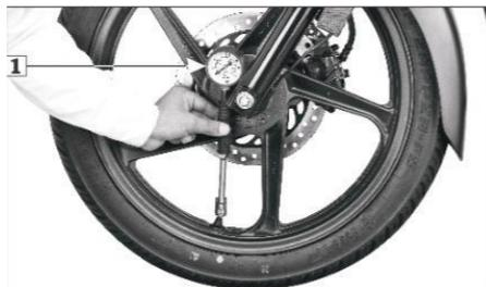
1. Manómetro presión de neumático
