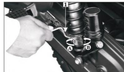
1. Herramienta de ajuste del amortiguador
