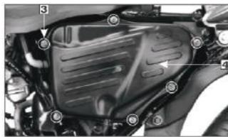
1. Tornillos/arandelas cubierta filtro de aire
