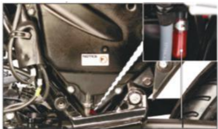
1. Tubo de drenaje
